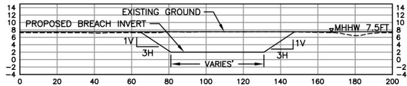
LEVEE BREACH – TYPICAL SECTION
